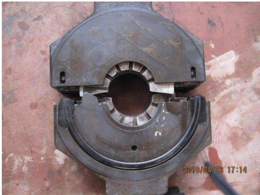
Figura 2.11: Gaveta de tubo com diâmetro variável (MALOUF, 2013)
