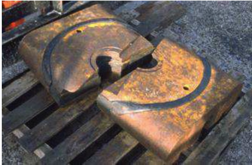
Figura 2.10: Gaveta de tubo com diâmetro fixo (MALOUF, 2013)
